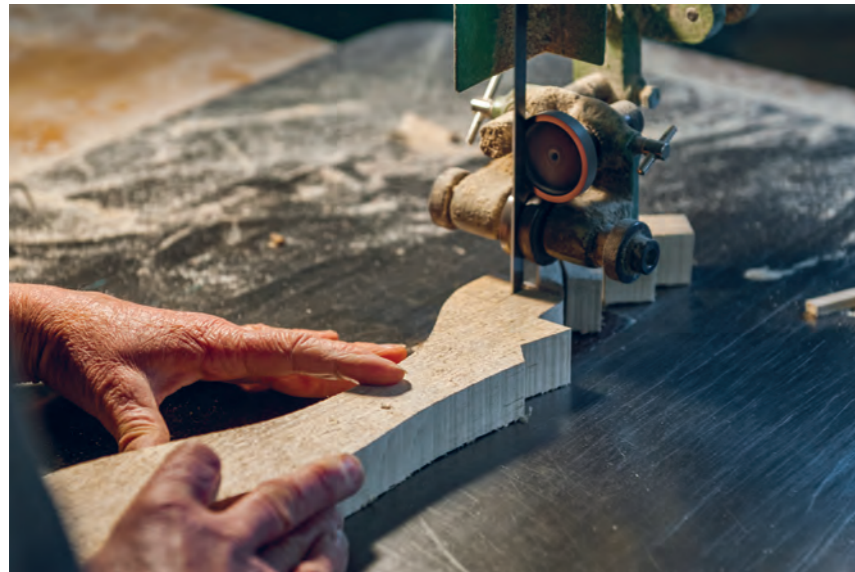
Die Beine der großen Odenwälder Schaukelpferde werden mit der Bandsäge ausgesägt.
