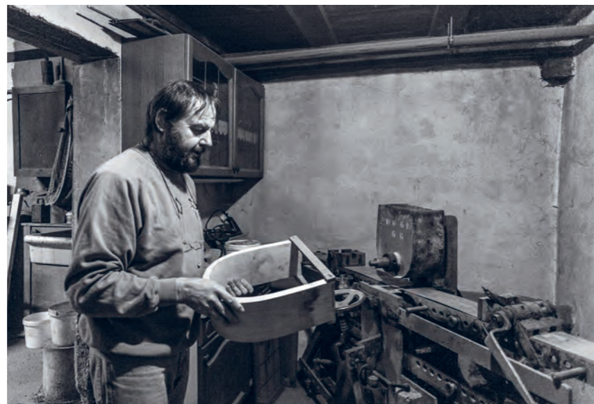
Die Rückenlehne der Schaukelpferde wird mit einer Holzbiegemaschine in die entsprechende Form gebogen.
